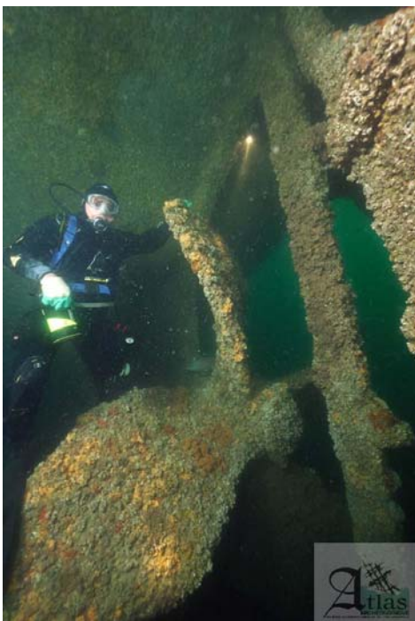
Hélice à quatre pâles en bronze – épave du Fetlar (©Teddy Seguin, ADRAMAR)
